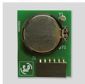
TIMER RTC ECOWATT (accessoire) Platine électronique additionnelle permettant, avec la console de programmation PROSYS ECOWATT, de faire travailler la tourelle suivant une programmation horaire. Jusqu'à trois plages horaires journalières. Période de vacances.
