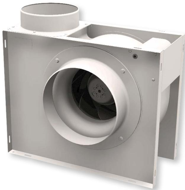
Gamme de ventilateurs centrifuges à entrainement direct. Construction métallique avec protection par peinture époxy. Clapet anti-retour au refoulement. Tous les modèles sont équipés d'une turbine centrifuge à action fabriquée en matériaux plastiques (800N) ou en tôle d'acier galvanisée (1500N).
