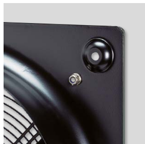
Résistance à la corrosion Platine emboutie, moteur support et grille de protection traitée par cataphorèse et protégée par une peinture polyester noire.
